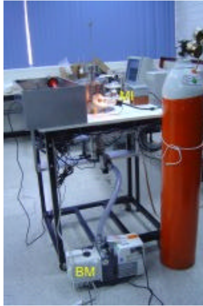
Figura 3.44 Prueba en vacío de la cámara Townsend obsérvese el sensor por ionización encendido MI, este solo funciona en presiones menores a 1 \times 10^{-4} torr , BM bomba mecánica.
