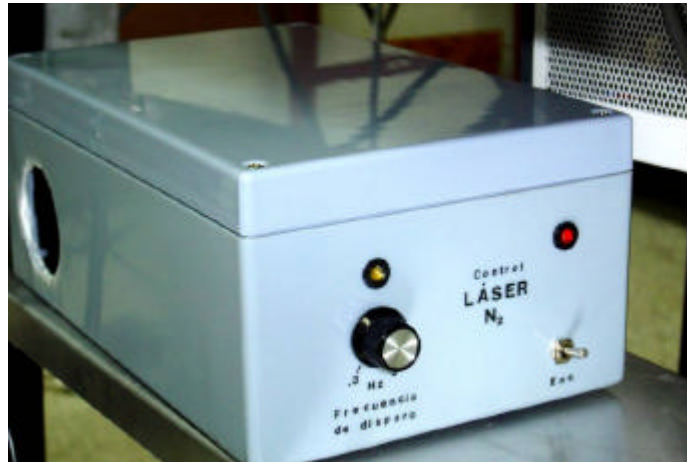
Figura 3.46 Detalle de la fuente de alimentación y control de disparo para el laser de nitrógeno.
