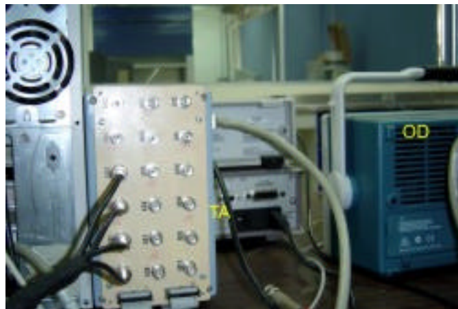
Figura 3.49 Detalle del diseño de la entrada de la tarjeta analógica digital Avantech® TA, mostrando cuatro canales para el sensado de los 4 puntos de temperatura en la cámara de Townsend.
