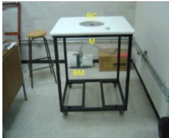
Figura 3.41 Mesa diseñada para la cámara de Townsend M mesa, BC base de la cámara, BM bomba mecánica.
