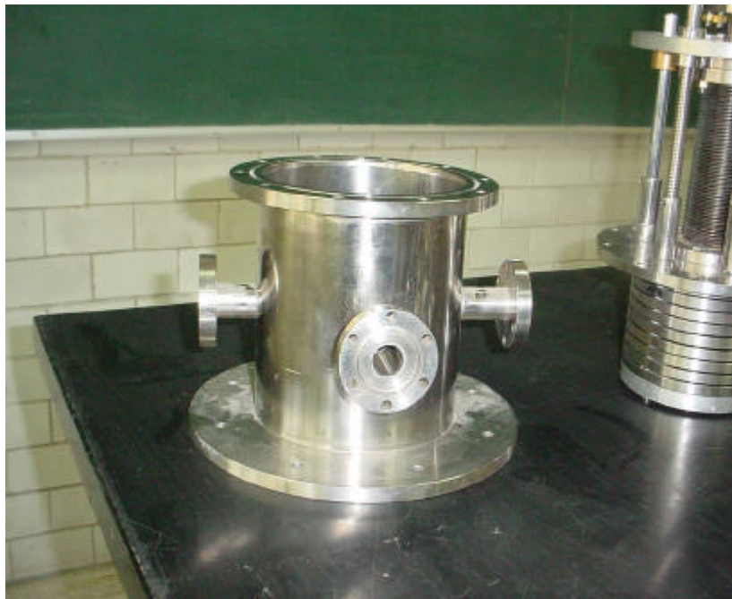
Figura 3.15 Cámara principal realizada en acero inoxidable.
