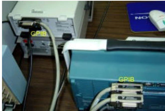
Figura 3.50 Detalle de las conexiones para la comunicación de los instrumentos con la tarjeta GPIB.
