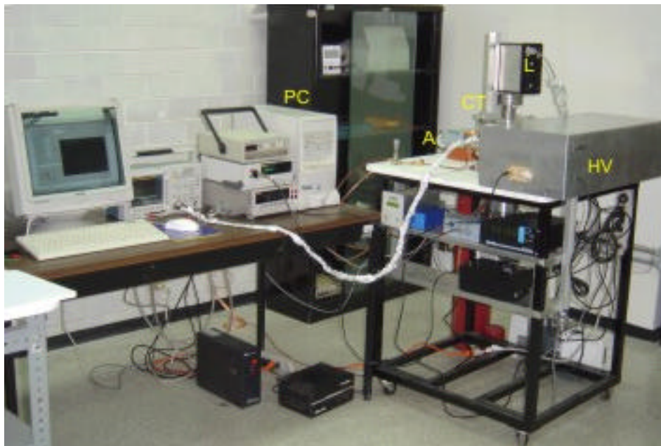
Figura 3.51 La cámara de descargas tipo Townsend completa.
